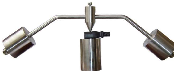
Afbeelding 6: Ball pressure test opstelling
