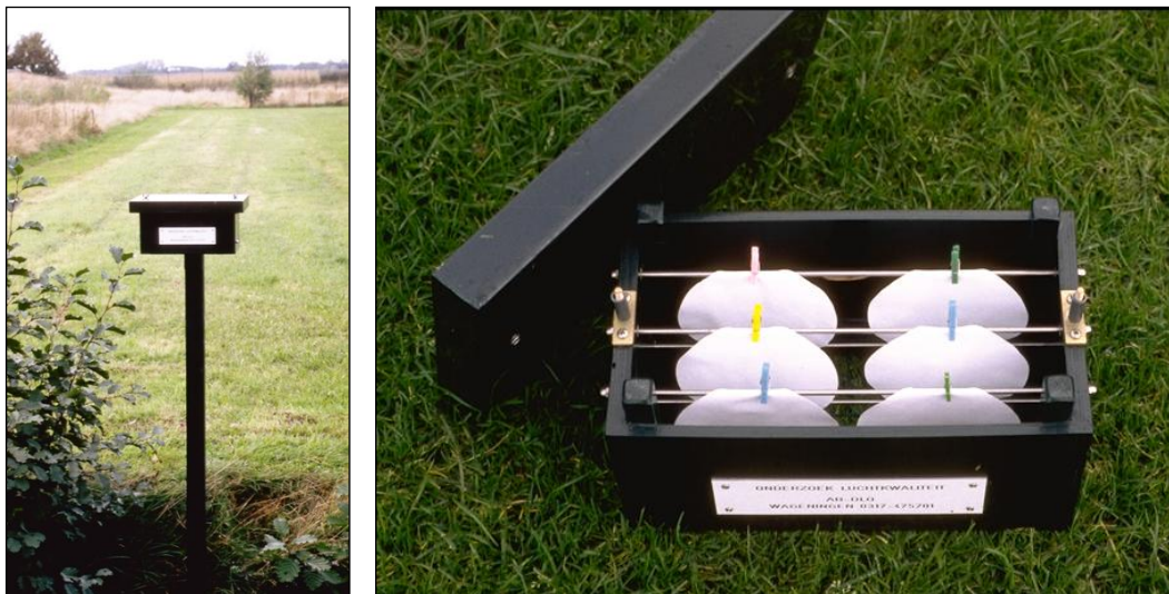
Figuur B2-3 Links een 'fluoridenkastje' in het veld en rechts een bovenaanzicht van het kastje met de geïmpregneerde filtreerpapertjes.
