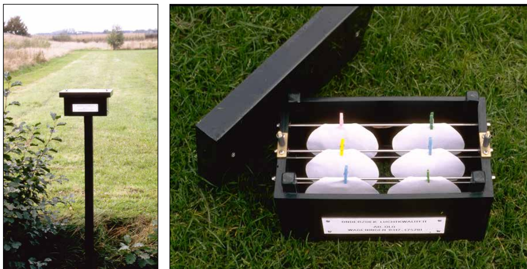
Figuur B2.3 Links een 'fluoridenkastje' in het veld en rechts een bovenaanzicht van het kastje met de geïmpregneerde filterpapiertjes.
